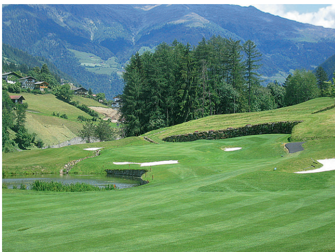
In fase di movimenti di terra, muretti in pietra sono utilizzati per compensare dislivelli tra le buche. Sopra, la buca 17 del Passiria GC in costruzione. Sotto, la stessa buca completata.
